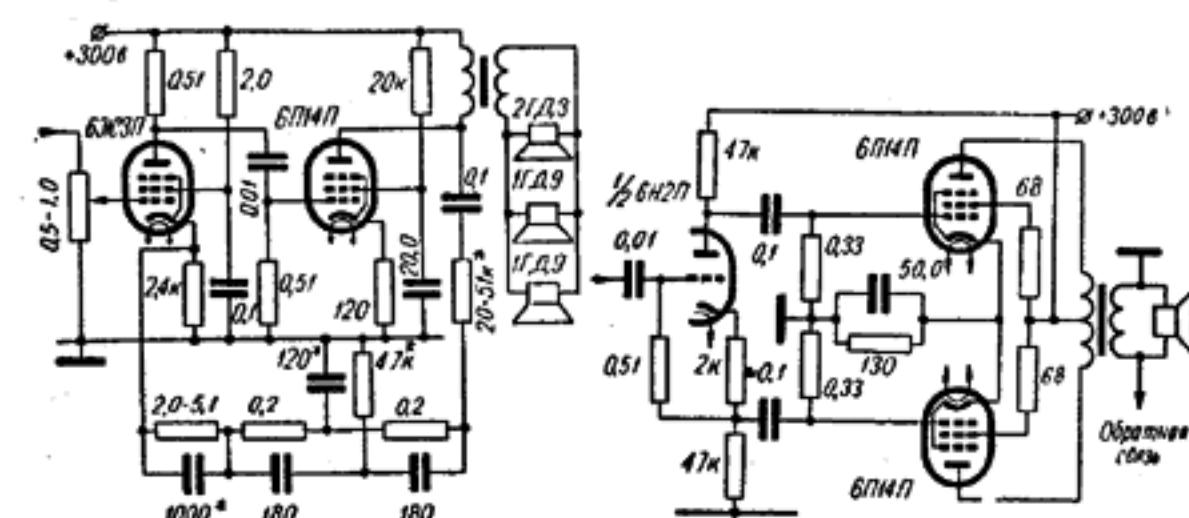
Рис. 411. Схема применения лампы 6П14П в однотактном усилителе низкой частоты.
