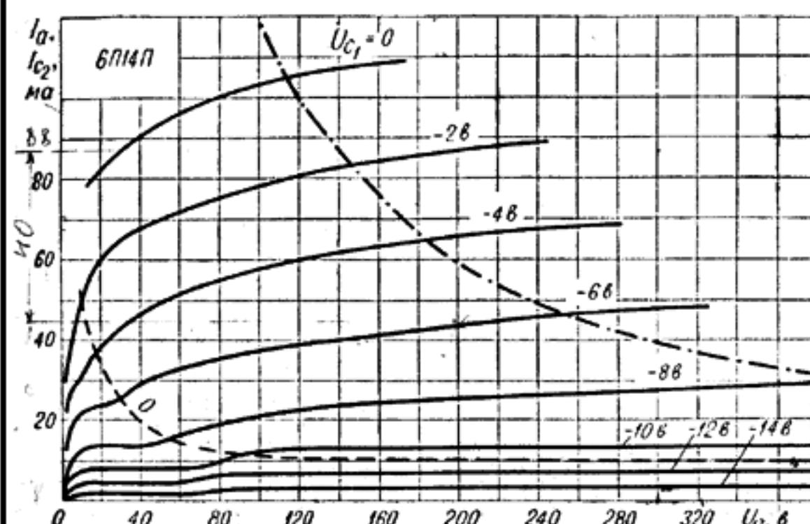
Рис. 416. Усредненные характеристики зависимости тока анода и тока второй сетки от напряжения на аноде при напряжении на второй сетке 250 в:
