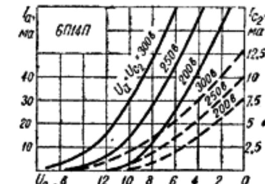
Рис. 414. Усредненные характеристики зависимости тока анода и тока второй сетки от напряжения на первой сетке:
