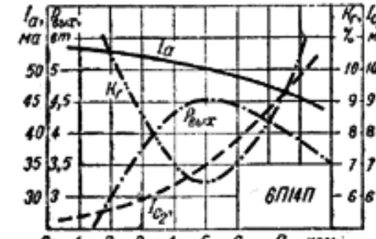
Рис. 413. Усредненные характеристики зависимости основных параметров от сопротивления нагрузки при напряжении на аноде и на второй сетке 250 в, напряжении на первой сетке — 6 в и переменном напряжении сигнала на второй сетке 3,4 в эф.
